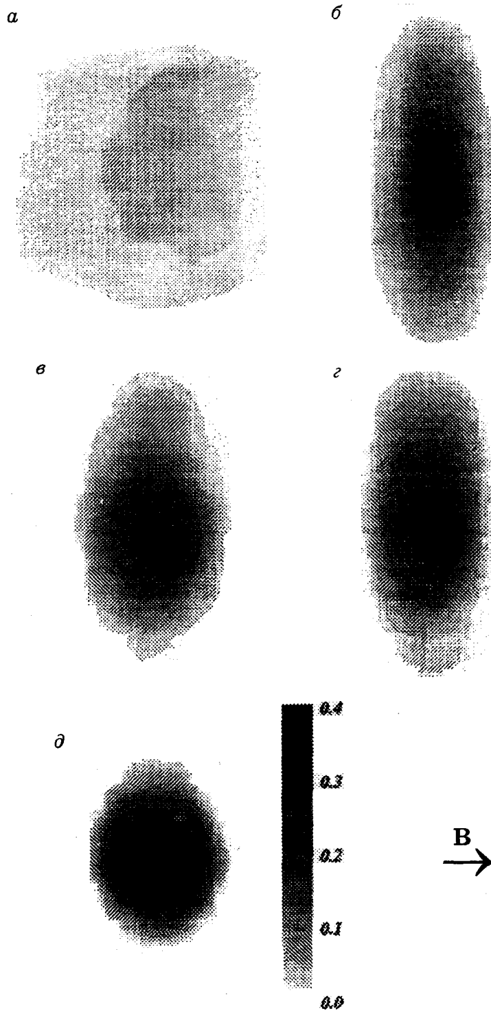
Рис. 3. Распределения объемной доли газовой фазы при числе Рейнольдса Re = 9300 и различных значениях числа Гармана Ha и параметра МГД взаимодействия N : a - Ha = 0, N = 0 ; б - Ha = 845, N = 77 ; в - Ha = 1505, N = 244 ; г - Ha = 2410, N = 625 ; д - Ha = 2710, N = 790 .
